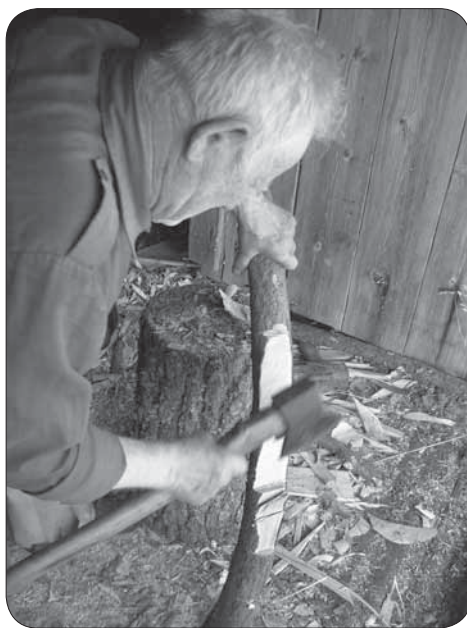
Рис. 18. Изготовление шпангоута. Мастер П. И. Тергоев (фото Н. Д. Столярова, 2004 г.)
