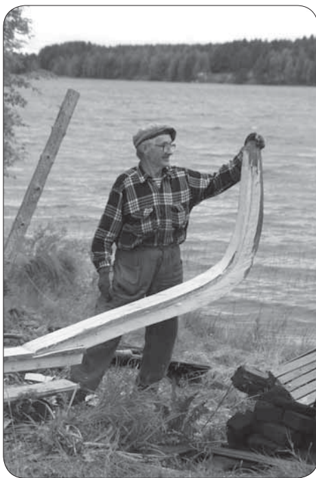
Рис. 10. Т. П. Сергеев строит лодку на берегу Кимасозера. Хорошо видно Т-образное сечение киля и соединение форштевня в «косой» замок (фото автора, 2010 г.)
