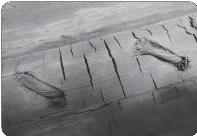
Рис. 5. «Стежки» из корня с клинышками. Часть борта «сшитой» лодки. Музей с. Юшкозеро (фото автора, 2011 г.)
