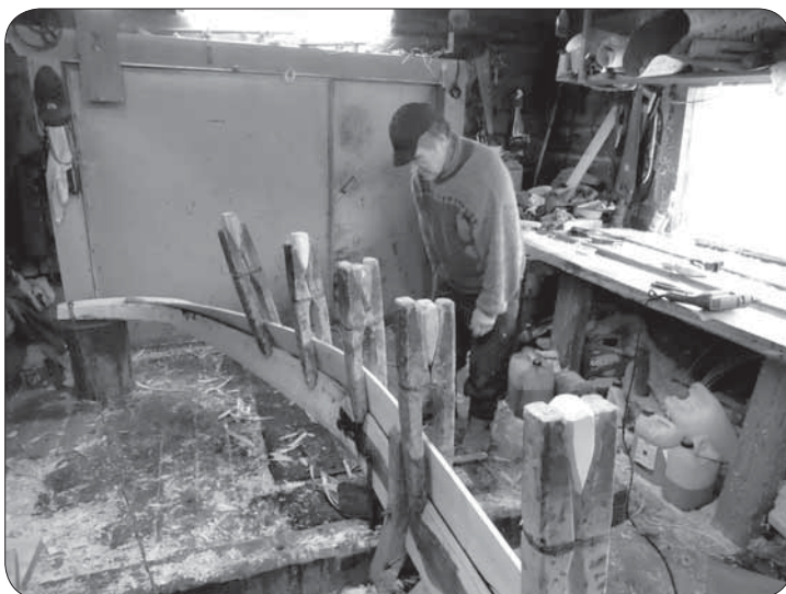
Второй день. Установка и подгонка первого набоя правого борта (фото автора, 2011 г.)
