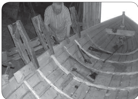
Рис. 21. Установка внутреннего бруса-«порубня» в корпус лодки. Мастер П. И. Тергоев (фото Н. Д. Столярова, 2004 г.)
