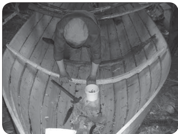
Рис. 20. Установка шпангоутов (фото Н. Д. Столярова, 2004 г.)
