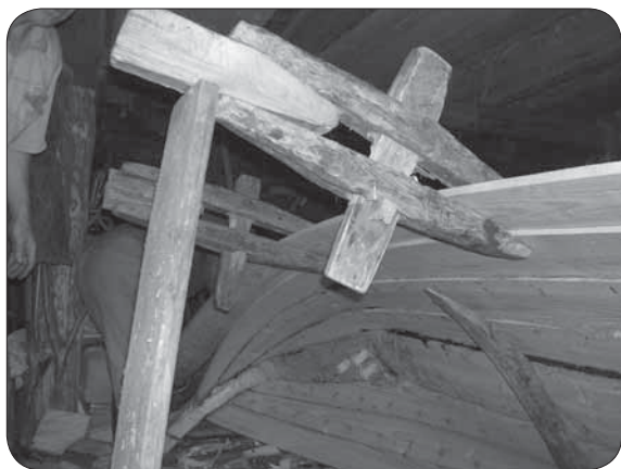
Рис. 17. Шитьё бортов лодки (фото Н. Д. Столярова, 2004 г.)
