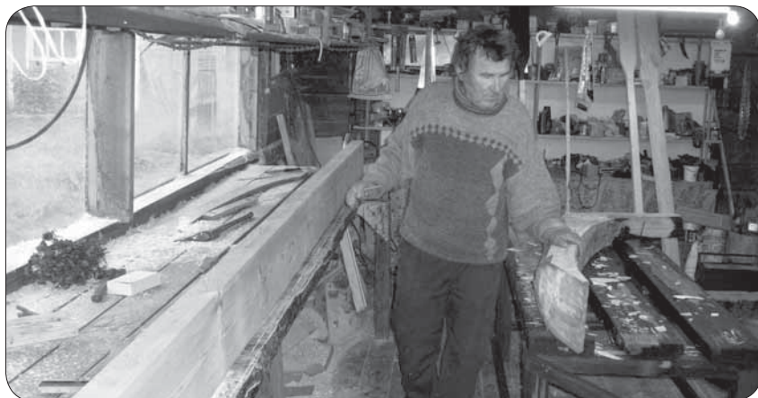
Начало работы по изготовлению киля и штевня (фото автора, 2011 г.)
