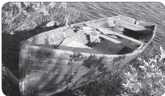
Рис. 25. Лодка с передним — «шоуттателлёт» и нижним — «похьятеллёт» настилами и кормовым сиденьем — «перяистун» (фото автора, 2010 г.)
