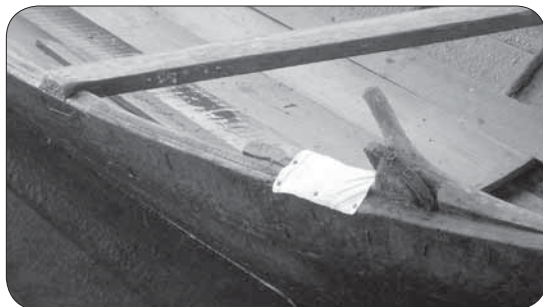
Рис. 26. Вставка уключины-«ханга» с петлёй и доска-«пентури» (фото автора, 2010 г.)
