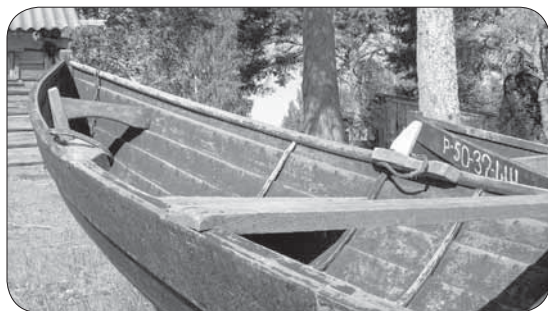
Рис. 21. Доска-«пентури» и доска в носу лодки (фото автора, 2010 г.)
