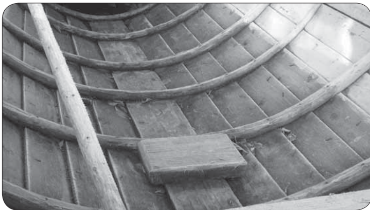
Рис. 12. Шпангоуты из стволов сосны и ели в корпусе лодки Ведлозера (фото автора, 2009 г.)
