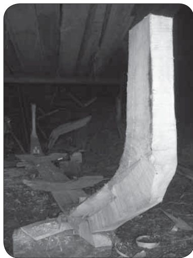
Рис. 15. «Эмяпуу» – киль со штевнями, основа лодки в мастерской П. И. Тергоева, д. Трофим-Наволок (фото Н. Столярова, 2008 г.)
