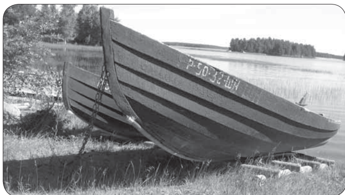
Рис. 24. Фальшкиль лодки, с. Вокнаволоок (фото автора, 2010 г.)
