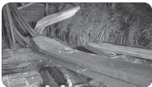
Рис. 25. Киль – «эмя» лодки мастера П. И. Тергоева (фото автора, 2010 г.)
