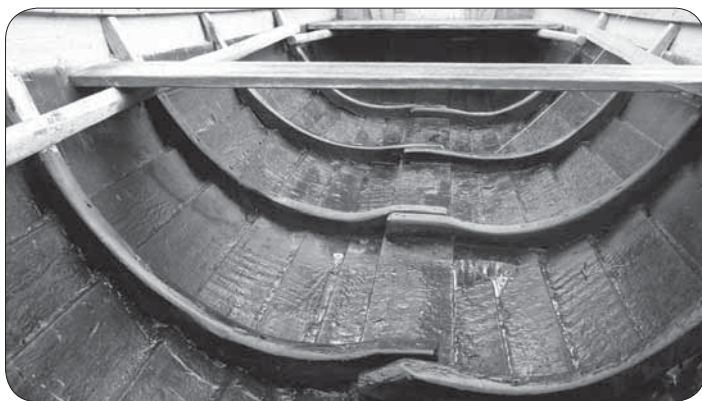
Рис. 13. Ветки шпангоутов из стволов кривых деревьев (фото автора, 2009 г.)
