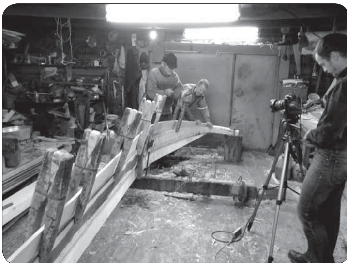
Второй день. Установка первого набоя левого борта (фото автора, 2011 г.)
