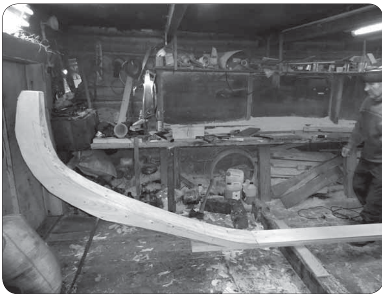
Соединение «кокки» с килем в замок (фото автора, 2011 г.)
