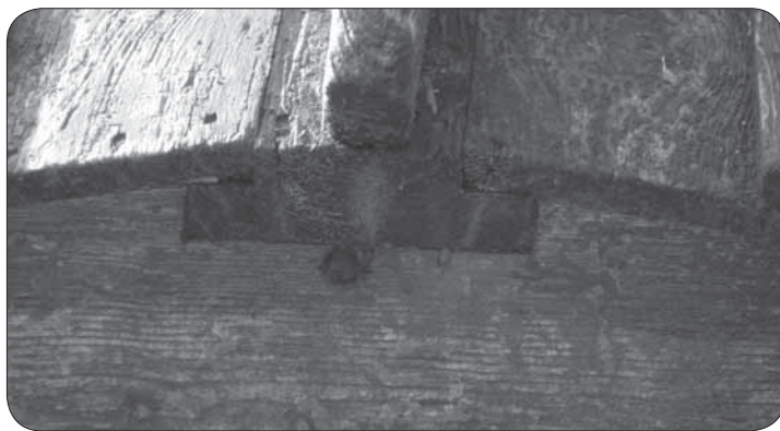
Рис. 11. Киль и сливное отверстие-«лоукко» лодки Ведлозера (фото автора, 2009 г.)
