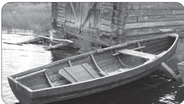
Рис. 21. Новая лодка с транцевой кормой мастера М. Ф. Копполова в д. Селецкое (фото автора, 2009 г.)
