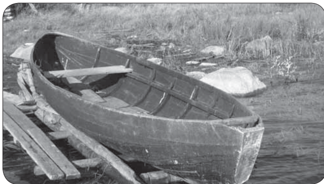
Рис. 10. Современная двухкорная лодка с транцем под мотор (фото автора, 2009 г.)
