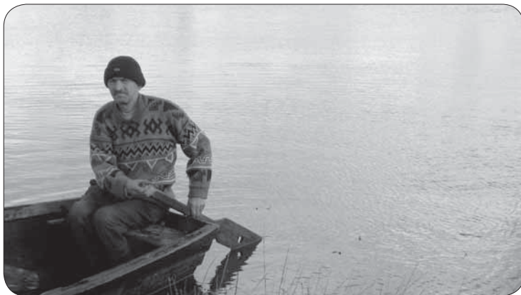
Рис. 14. Управление лодкой при помощи кормового весла — «мела», д. Кинелахта (фото автора, 2009 г.)
