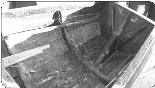
Рис. 8. Отверстие для слива воды с пробкой в киле лодки П. К. Антонова (фото автора, 2009 г.)
