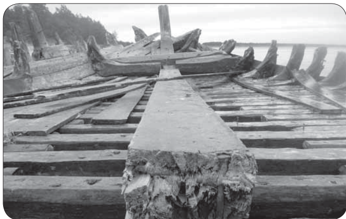
Переломленный кильсон олонцкого судна (фото автора, 2009 г.)
