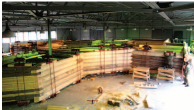
фото 14. Отреставрированный подклет памятника проходит испытание “Имитация нагрузки”
