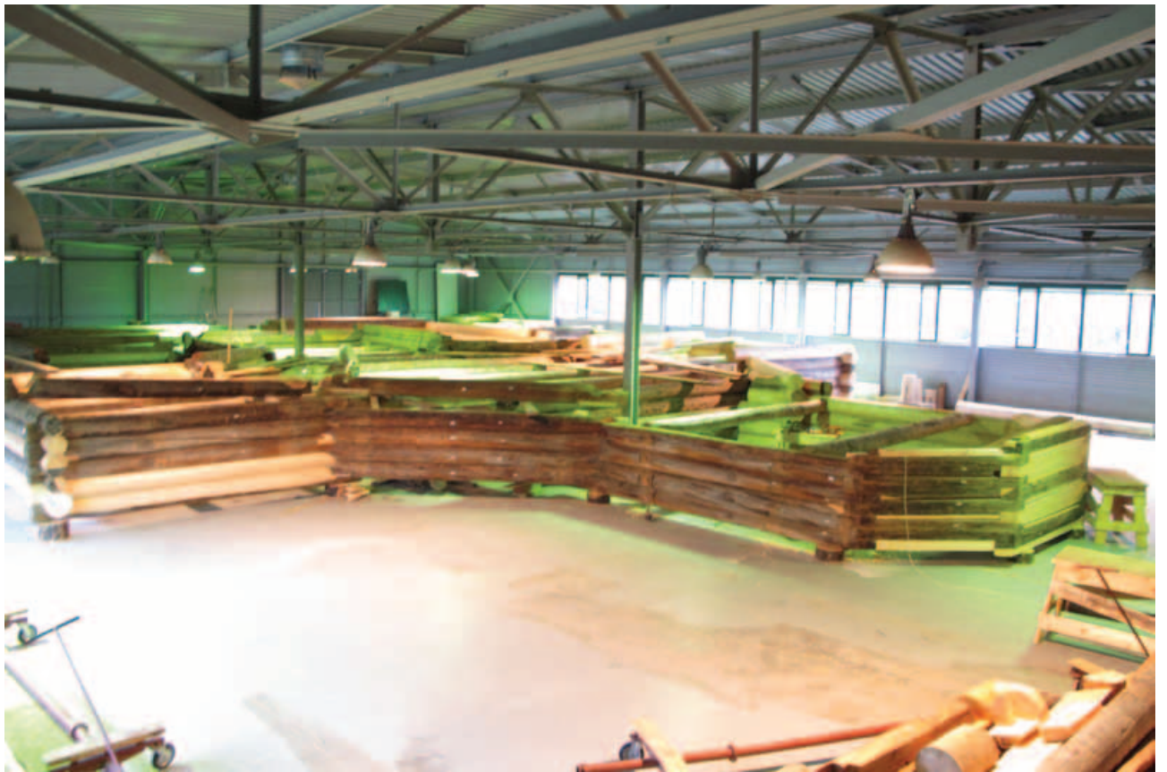
фото 11. Процесс сборки сруба
