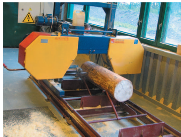
рис. 22. Ленточная пилорама в производственном корпусе реставрационного комплекса
