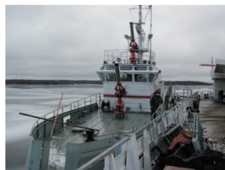
рис. 41. Пожарный катер "Вьюн" - насосная станция пожаротушения Кижского погоста производительностью 200л/сек
