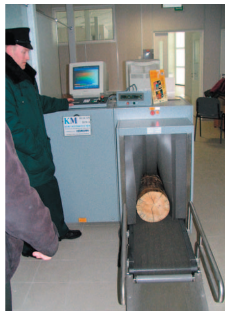
рис. 58. Таможенный интраскоп применен в качестве дефектоскопа древесины
